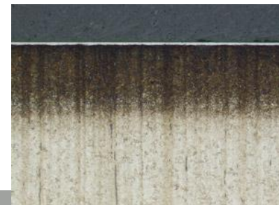
Fotodokumentace struktury nitridované vrstvy
